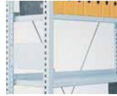
Aktenboden 30 mm dick, Sicherheitskan-tung vorne, rückseitig mit Anschlag, Boden und Stützrahmen schliessen bündig ab. Diagonalverstre-bung mit Spannschloß, verzinkte Ausführung, erforderlich in jedem zweiten Regalfeld.
