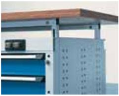
Höhenverstellbare Platte für ergonomisch richtige Arbeitshöhen, Verstellbereich 850 - 1050 mm, Klemmverstellung, nur bei Gehäusebreiten 1150 u.1695 mm.
