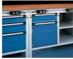
Variabel: die function ist mit und ohne Plattenüberstand erhältlich. Strom und Druckluft können bei Reihenaufstellung front- oder rückseitig durch die Funktionsleiste geführt werden.
