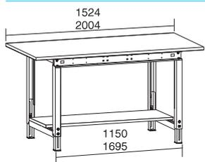
Belastbarkeit 350 kg bei gleichmäßig verteilter Last, mit Buche-Multiplexplatte 25 mm dick, oberflächenbehandelt gegen Verschmutzung
