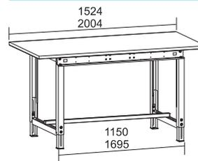
Belastbarkeit 350 kg bei gleichmäßig verteilter Last, mit melaminharzbeschichteter Platte, 28 mm dick, grau
