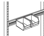
Aluminiumprofil, vierseitig verwendbar, zur Aufnahme von handelsüblichen Lagerkästen mit rückseitiger Einhängekante, neigbar 19°, steckbar
