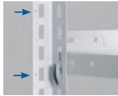
Les montants perforés permettent un montage rapide. Perforation au pas de 90 mm. Le montant est conçu pour accueillir les tablettes des deux côtés.
