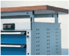
Plateau réglable en hauteur pour hauteurs de travail ergonomiques, plage de réglage comprise entre 850 -1050 mm, réglage par serrage, uniquement pour les largeurs de caisson 1150 et 1695 mm.
