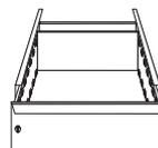
à fixer dans des structures ouvertes, charge max. admise de 60 kg, 80 % d'extension, dimensions intérieures L x P x H : 390 x 600 x 126 mm
