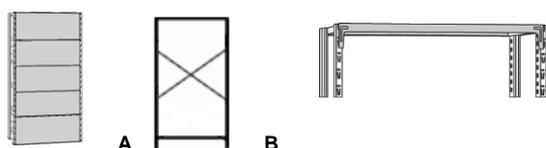
**C - Raidisseurs**, prévoir un en haut et un en bas. Permettent un accès des 2 côtés du rayonnage (double face).
