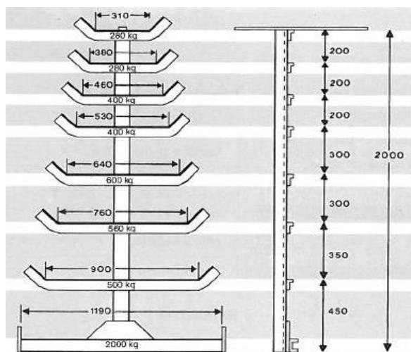
Charges maxi pour un rayonnage double face; pour un modèle simple face, diviser ces charges par 2.
