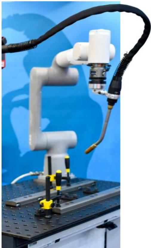
Le poste multi4flex a été étudié spécialement pour les travaux de soudage léger et peut être aussi bien adapté au travaux manuels que à l'aide d'un Cobot.
